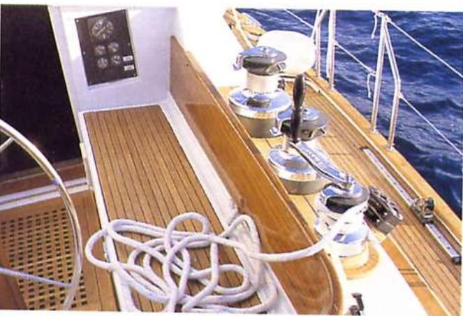
La ruota della timoneria Solimar (in alto) con la bussola Riviera. Gli strumenti elettronici di navigazione sono ben in vista del timoniere. Sulla tuga si intravedono i due verricelli per le drizze con i relativi stopper. Qui sopra, il lato di dritta del pozzetto con i tre verricelli Antal a tre ed a due velocità.
